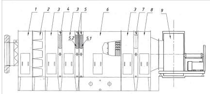
Рис. 1. Схема типового центрального кондиционера КТЦЗМ-80
